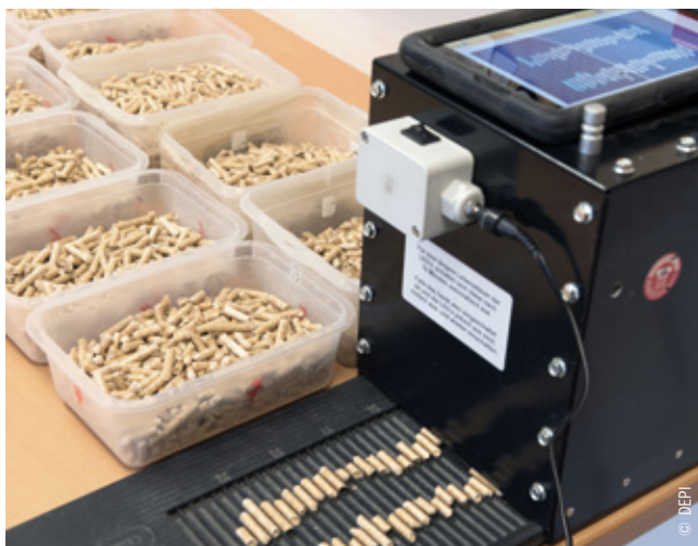
Testen der Pelletproben, um die Einhaltung der Qualitätsanforderungen des Zertifizierungsprogramms ENplus nachzuweisen.
