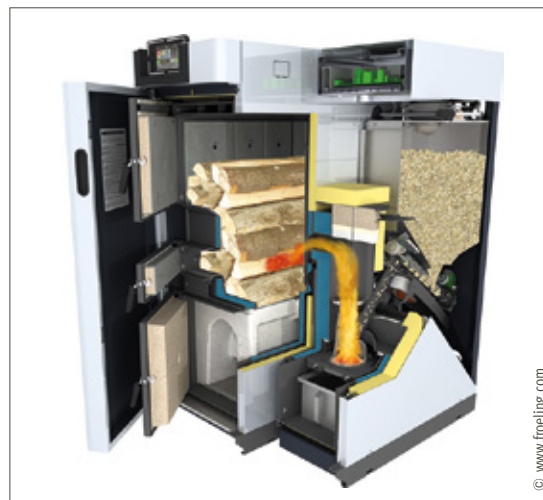
Die Pelletseinheit am Scheitholzessel lässt sich bei einigen Modellen auch später bei Bedarf nachrüsten.
